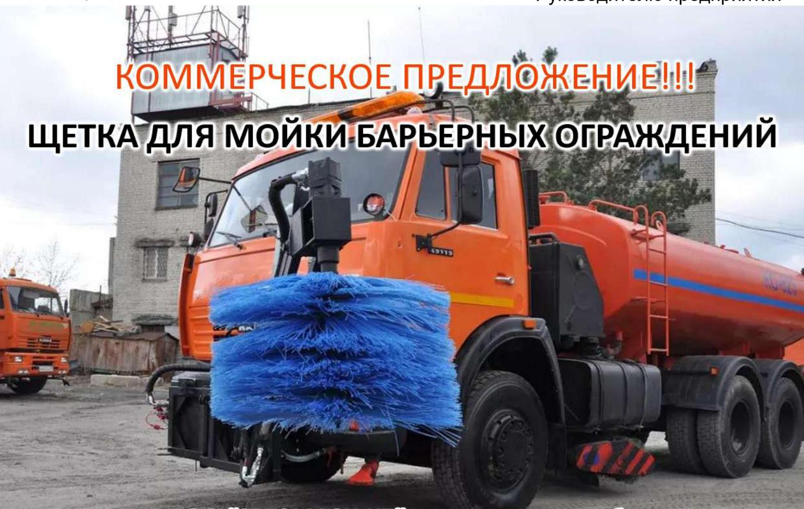
**Компания ТОО "SPESMASH KZ" предлагает приобрести Щетку для мойки барьерных ограждений. Предназначена для очистки с увлажнением дорожных металлических ограждений барьерного типа.**
