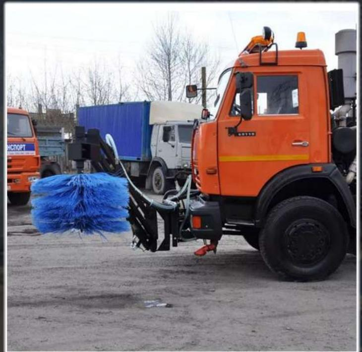
Щетка для мойки барьерных ограждений предназначена для очистки с увлажнением дорожных металлических ограждений барьерного типа. Подвод воды осуществляется от насоса высокого давления.
