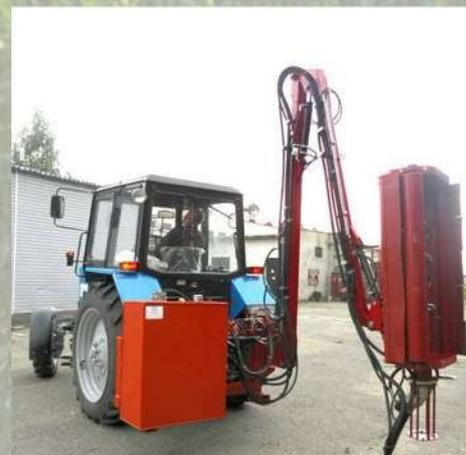
Косилка ЕМ 1,3-01 с режущей головкой применяется для удаления с обочин дорог, откосов, кюветов, за барьерным ограждением и разделительных полос травы и кустарника до 20 мм. Данный рабочий орган перемалывает в мелкую фракцию срезанный материал. Применение данного типа оборудования значительно снизит затраты на сбор и утилизацию срезанной травы и кустарника.
