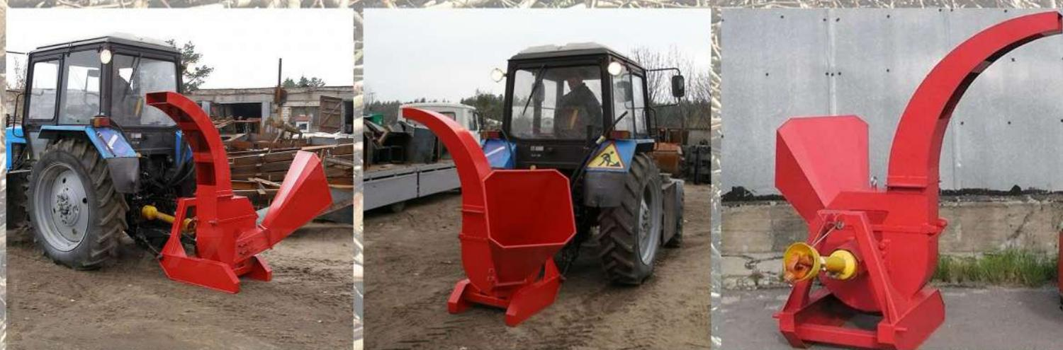
**Измельчитель веток работает по принципу самозатягивания древесных отходов. Расположенные на диске ножи втягивают древесину и измельчают её. Находящиеся на диске лопасти выбрасывают щепу через выгрузной желоб. Агрегируется на трехточечную сельхознавеску с тракторами тягового класса 1,4тн.**
