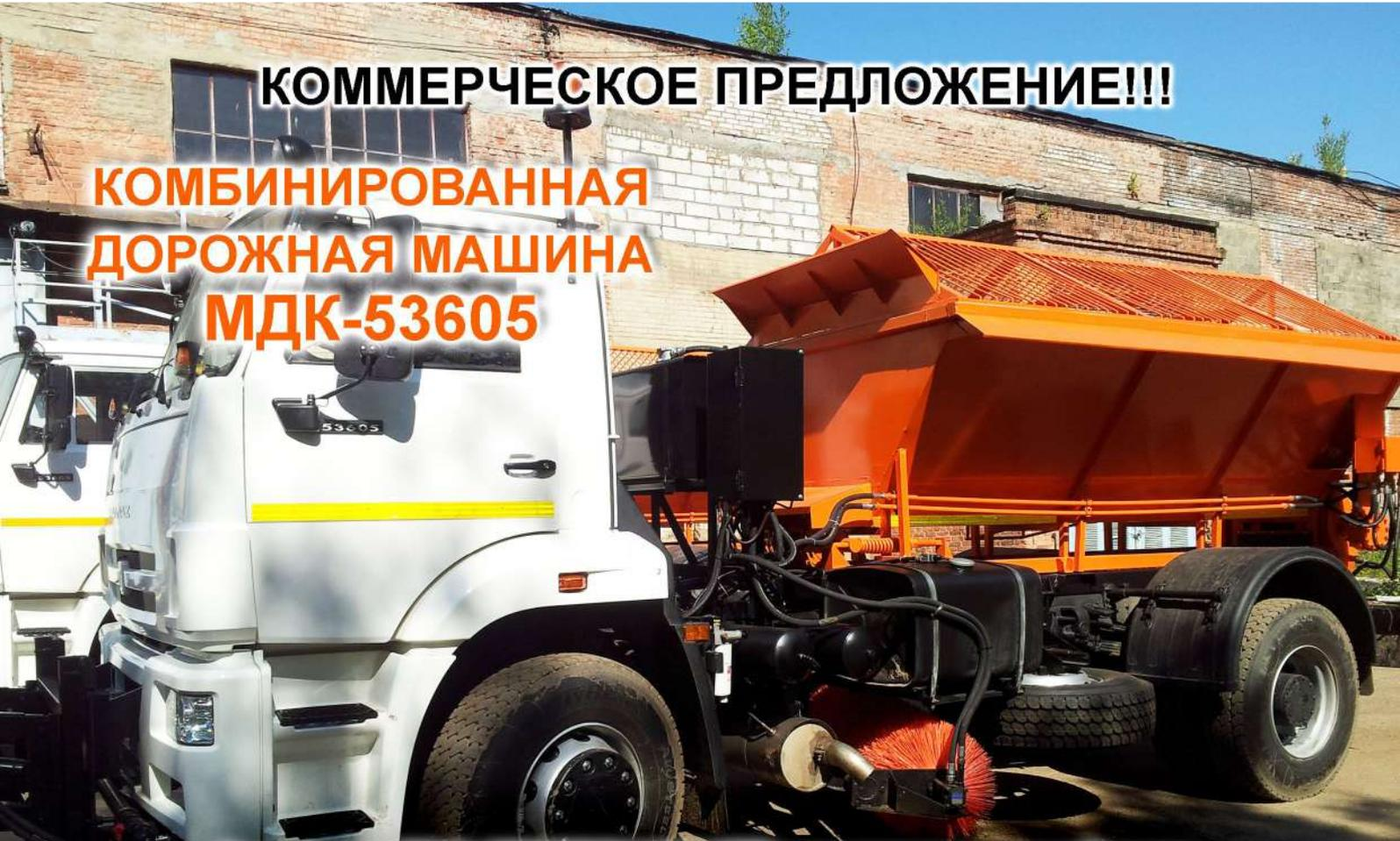
Компания ТОО "SPESMASH KZ" предлагает приобрести Комбинированную дорожную машину МДК-53605 на базе шасси КамАЗ-53605 (4x2). Машина может оснащаться: пескоразбрасывающим оборудованием с емкостью 6,5 куб.м., межбазовым щеточным оборудованием, гидроповоротным коммунальным отвалом, поливомоечным оборудованием с емкостью 10 куб.м.
