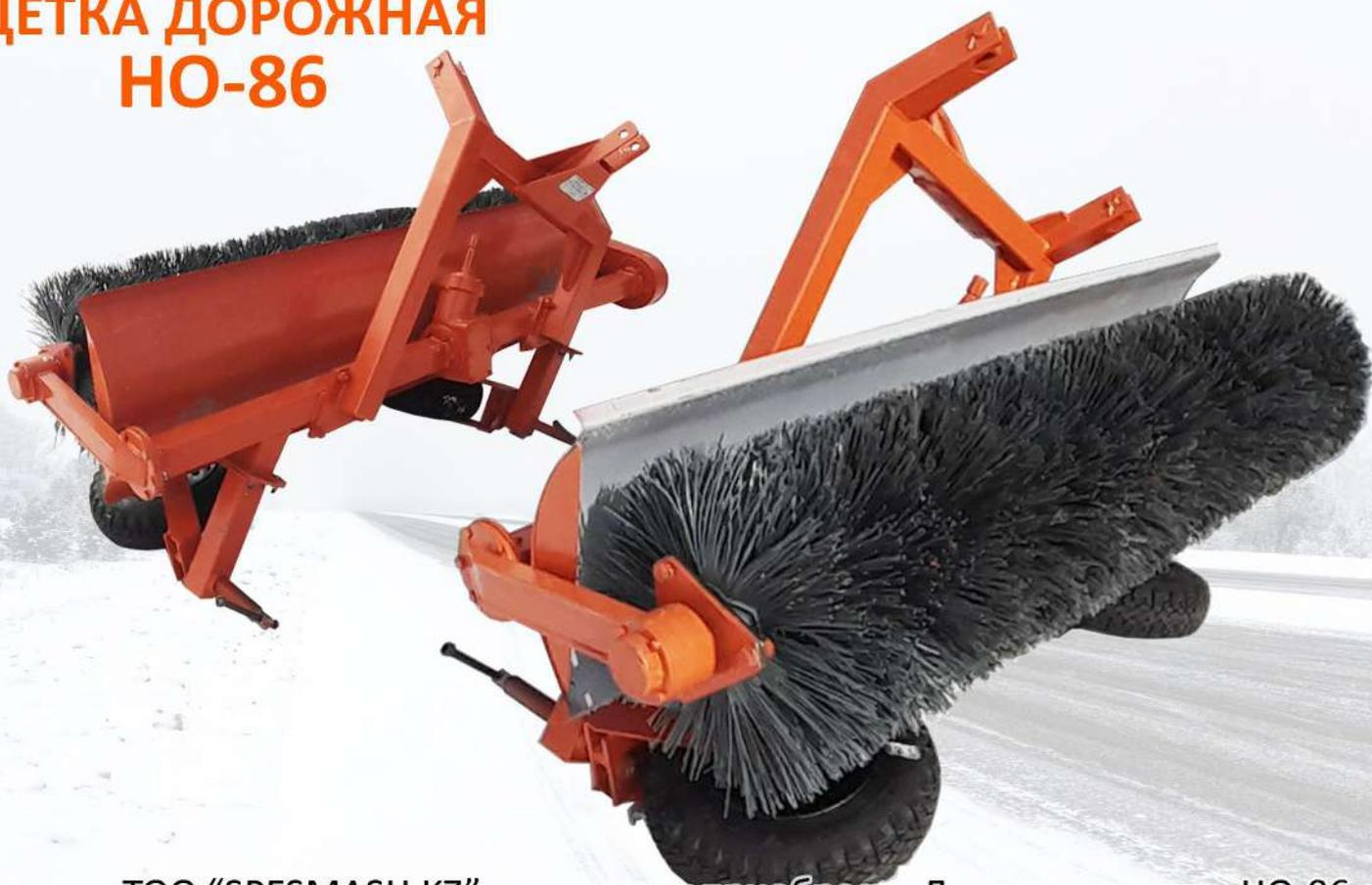
Компания ТОО "SPESMASH KZ" предлагает приобрести Дорожную щетку НО-86 для уборки территорий на трактор с тяговым классом 1,4. Ширина убираемой поверхности, при угле 30 градусов, составляет 1800 мм. Максимальная высота убираемого свежеснег выпавшего снежного покрова - 500 мм.
