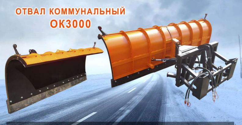
Компания ТОО "SPESMASH KZ" предлагает приобрести Коммунальный гидроповоротный отвал ОК3000 для комбинированной дорожной машины. Ширина очистки в прямом положении 3 метра, угол поворота 30 градусов.
