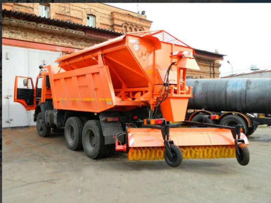
Щетка задняя предназначена для круглогодичного содержания автомобильных дорог, в летний период для сметания мусора с дорожного полотна, в зимний период для сметания свежесвыпавшего снега.
