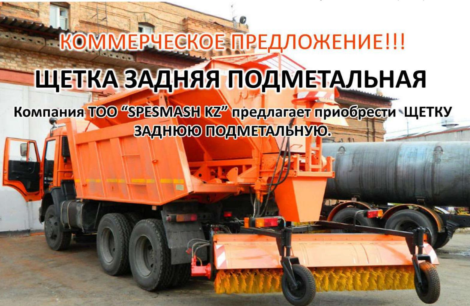
**Щетка задняя предназначена для круглогодичного содержания автомобильных дорог, в летний период для сметания мусора с дорожного полотна, в зимний период для сметания свежесвыпавшего снега.**
