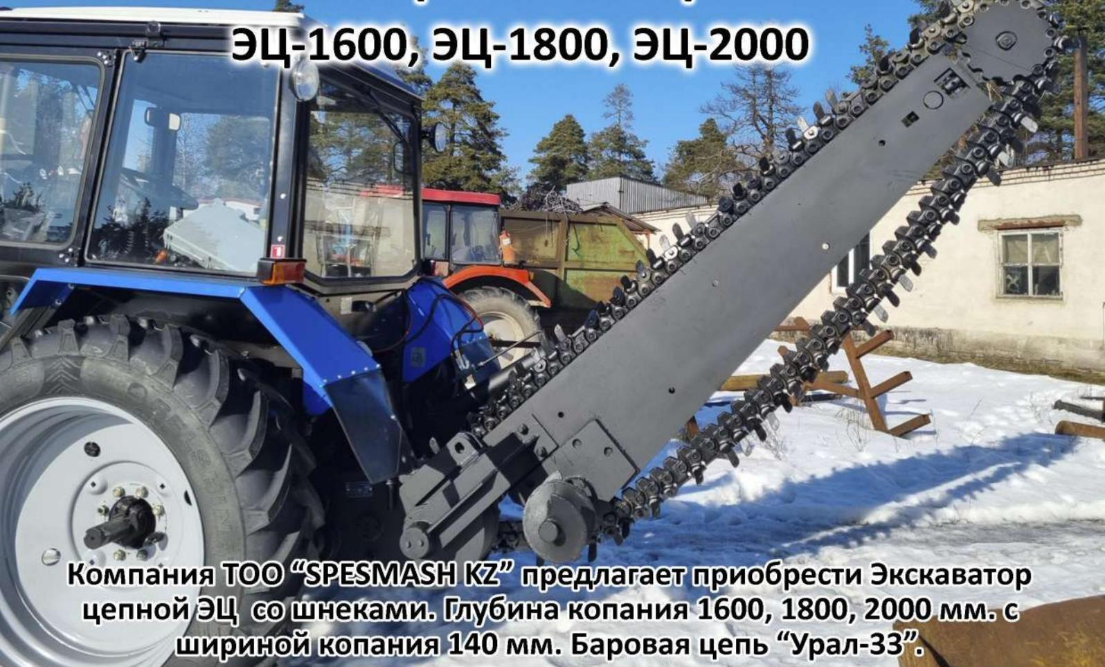
Компания ТОО "SPESMASH KZ" предлагает приобрести Экскаватор цепной ЭЦ со шнеками. Глубина копания 1600, 1800, 2000 мм. с шириной копания 140 мм. Баровая цепь "Урал-33".
