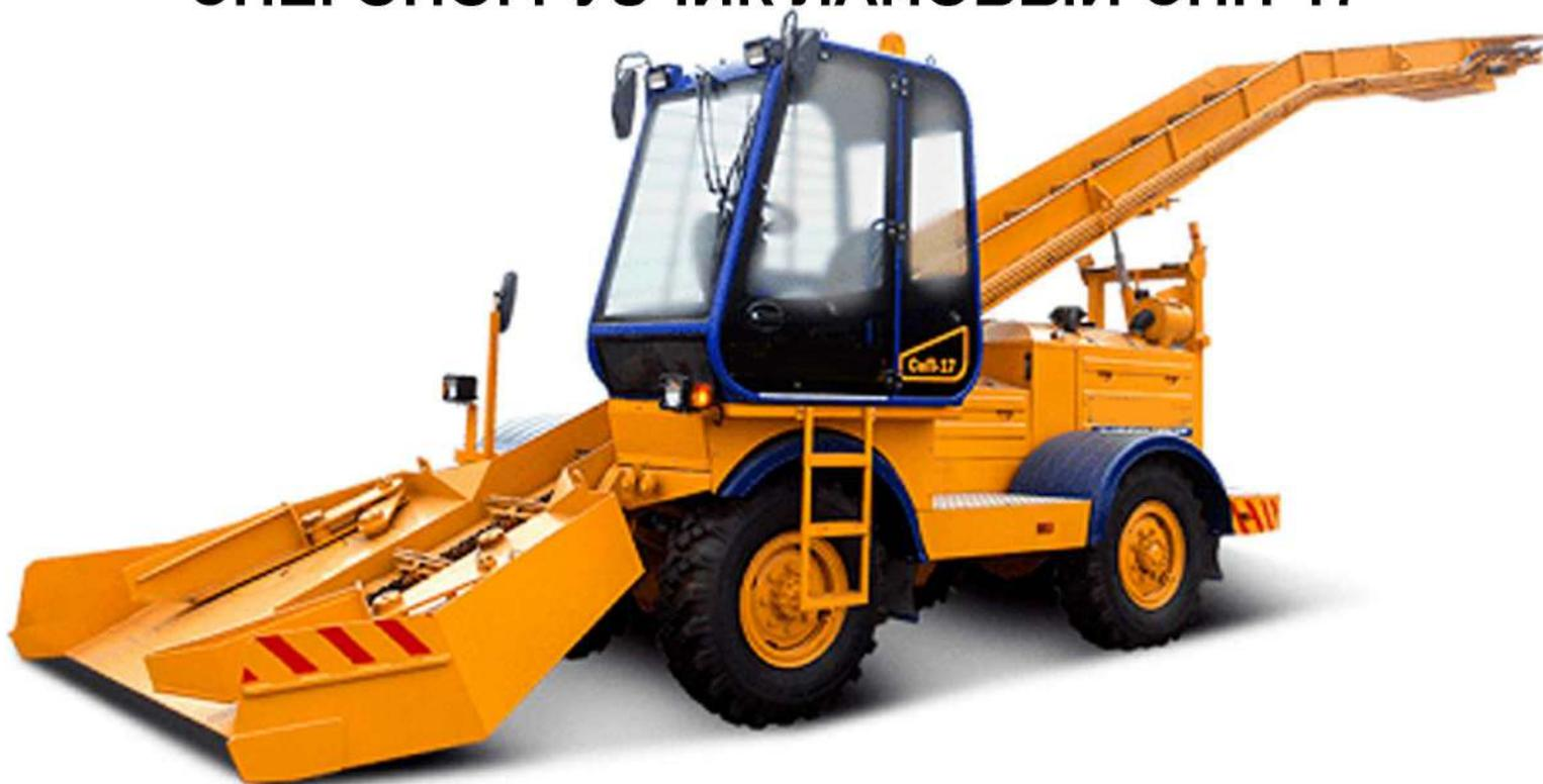
Компания ТОО "SPESMASH KZ" предлагает приобрести Лаповый снегопогрузчик СнП-17. Максимальная высота погрузки 4400 мм. Вылет транспортёра 5600 мм.
